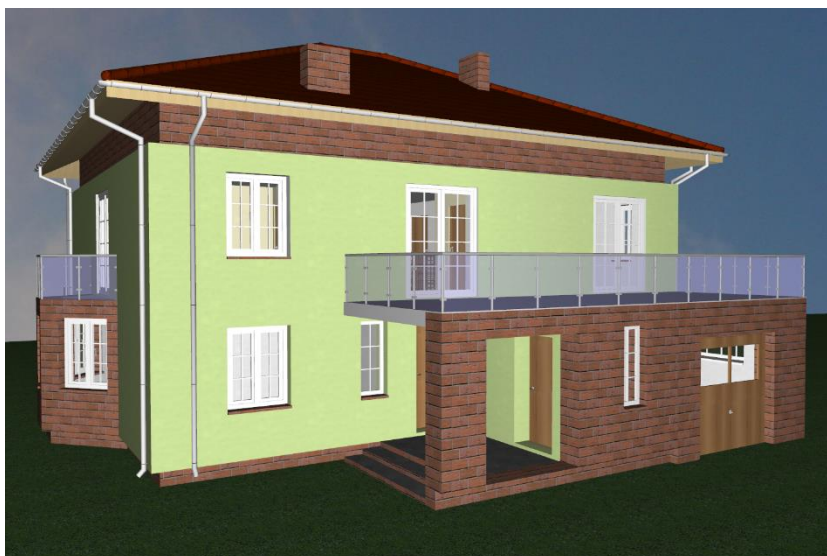
Rys. 76 Przykład wprowadzenie balustrady na tarasie
