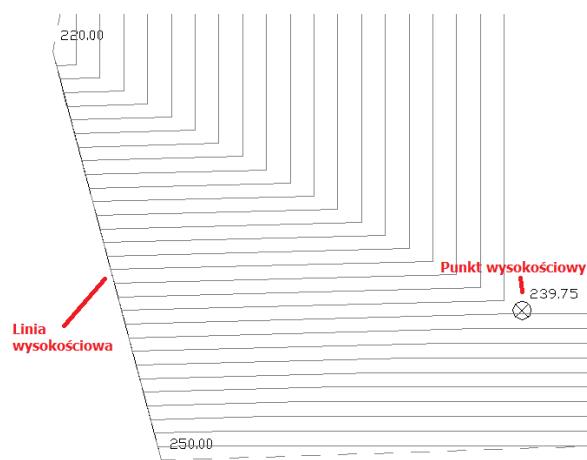
Rys. 90 Elementy terenu na rzucie
