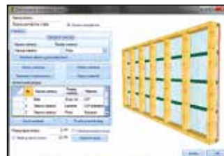
WoodCon: Konstrukcja ściany
