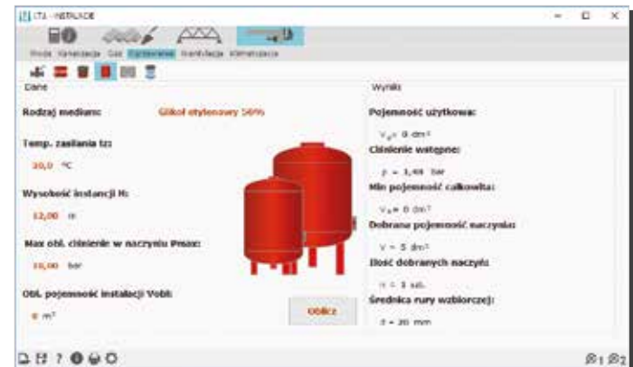
I.T.I. INSTALACJE- OGRZEWANIE: Pojemność zamkniętego naczynia wzbiorczego
