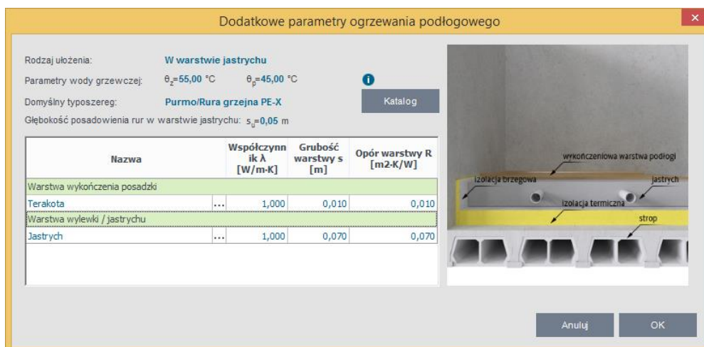
Okno dodatkowe parametry ogrzewania podłogowego ułożenie w warstwie jastrychu
