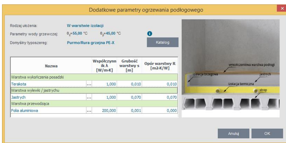
Okno dodatkowe parametry ogrzewania podłogowego ułożenie w warstwie izolacji
